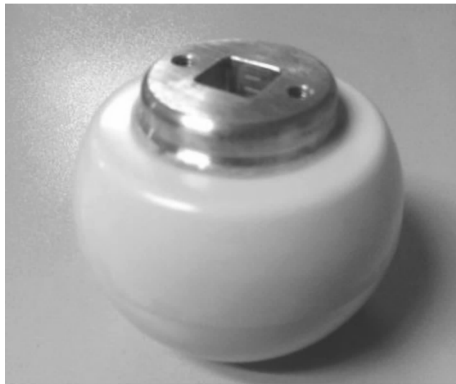
图4 72.5 kV 支撑绝缘子实物图
